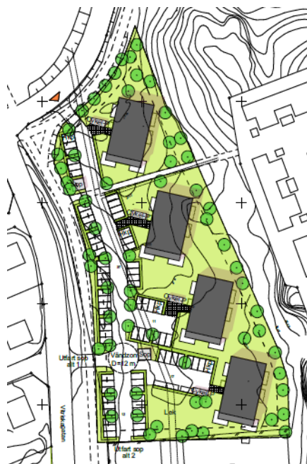
Illustrationsplan från Stadsutveckling hur flerbostadshus inom området skulle kunna placeras. Copyright EttElva Arkitekter.
